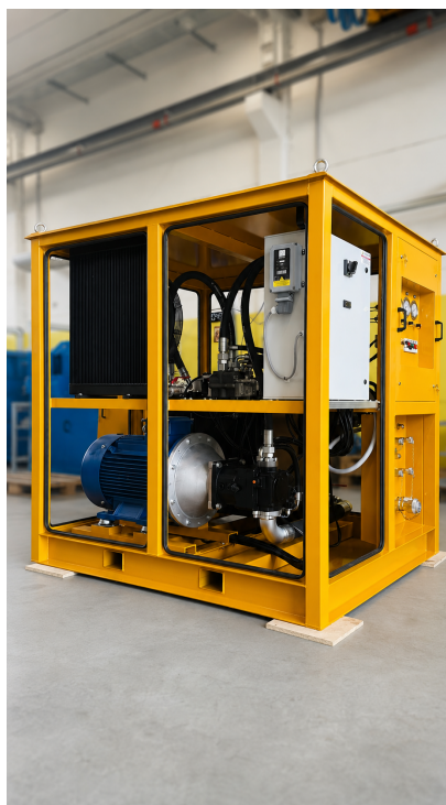
Vista interna Da usare per mostrare integrazione di motore, pompa, tubazioni e quadro.
